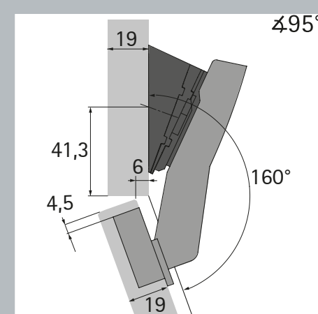
Sensys 8639i W45 B-2 pro naložené dveře 9 088 019 mont. podložka 0 mm 9 071 575 úhlová podložka 20° a 5° 9 072 217 a 9 072 214
