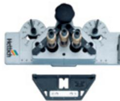
Para el montaje preciso de bisagras en productos personalizados o especiales o para el equipamiento posterior de puertas en la empresa del cliente
